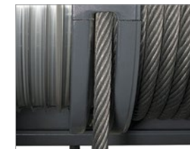
Guide-câble en fonte de graphite
