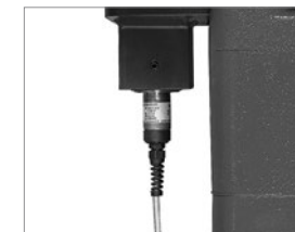
Limiteur de surcharge intégré
